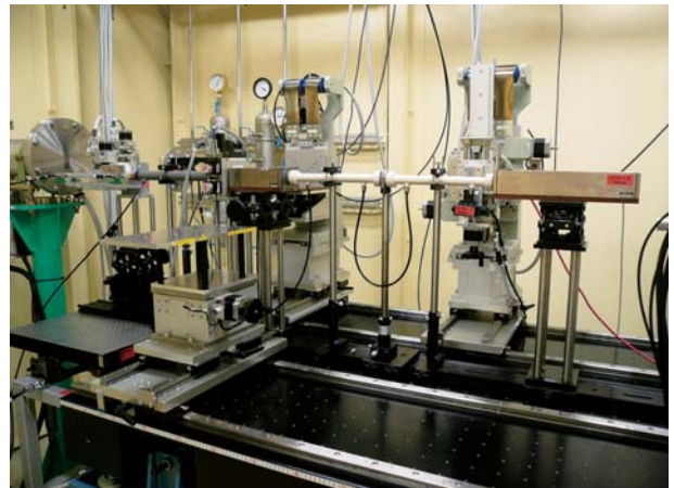
図2 XAFS測定装置（透過法配置）
