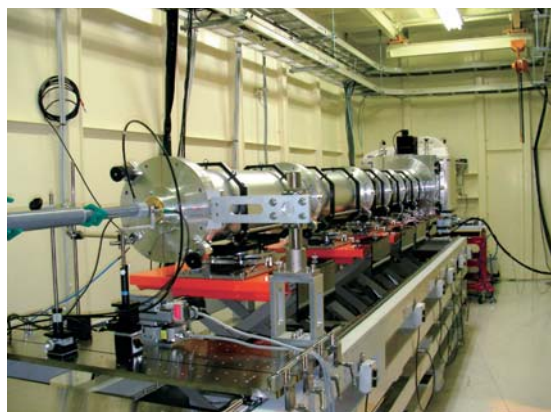
図1 新しい小角用定盤 (左：カメラ長4m、右：カメラ長2m)
