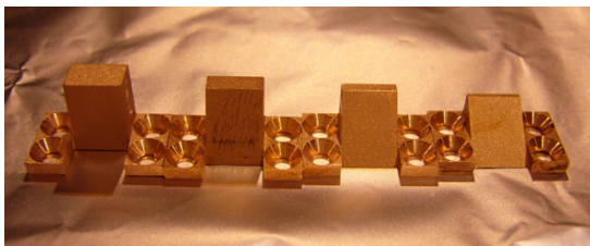
図2. 作製した硬X線光電子分光角度依存性測定用試料ホルダー
